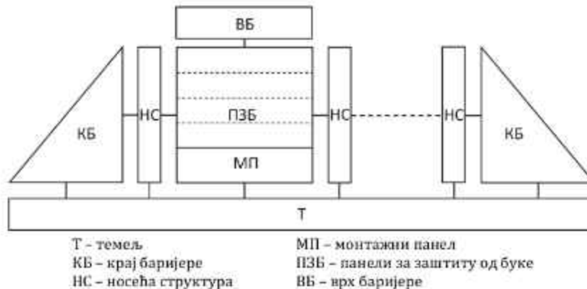
Слика 4.12 Шема поступка конфигурисања модуларне звучне баријере
