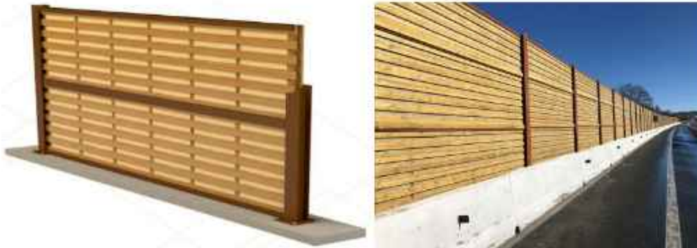
Слика 3.72. Примери дрвених баријера [69]
