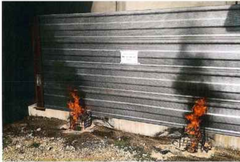
Слика 5.36. Испитивања панела СЗБ на отпорност на ватру шибља
