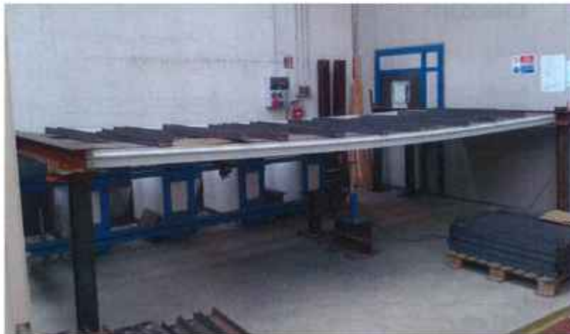
Слика 5.32. Испитивање панела за смањење саобраћајне буке на утицај ветра
