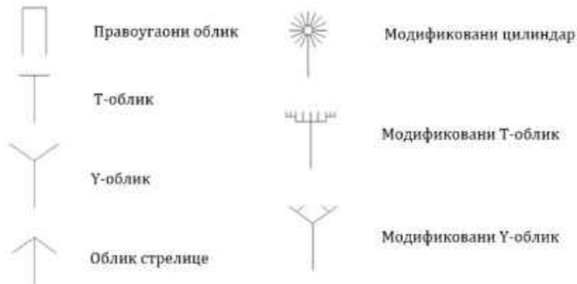
Слика 3.52 Различити облици дифракционих капа (Прилагођено из [60])
