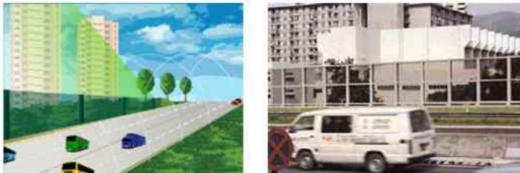
Слика 2.5. Приказ ефекта вертикалне баријере и изглед баријере [1]
