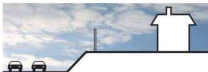
Слика 2.10. Пример постављања баријере код усечених путева [24]
