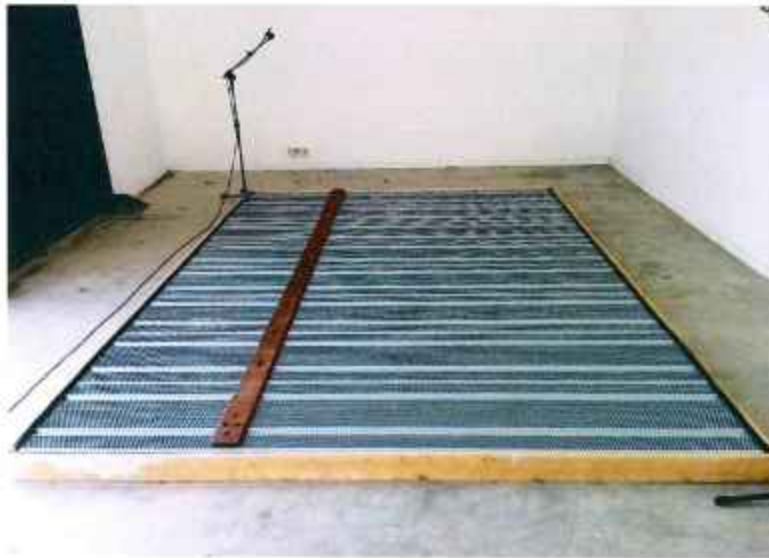
Слика 5.25. Испитивање узорка СЗБ у реверберационој комори
