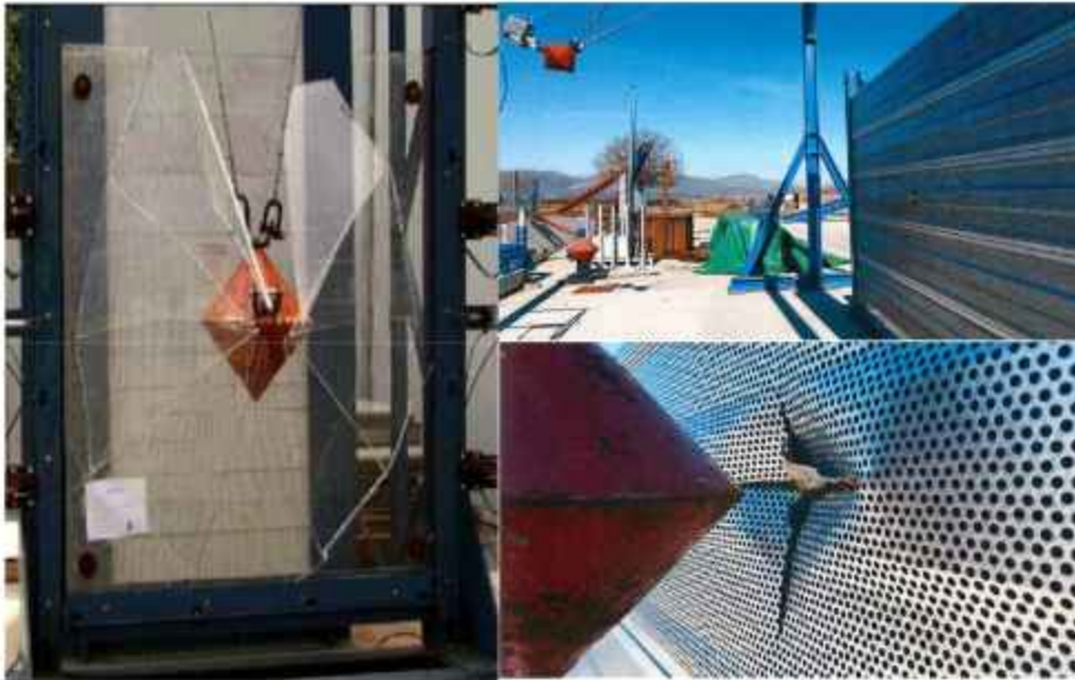
Слика 5.37. Испитивања секундарне сигурности СЗБ [114]
