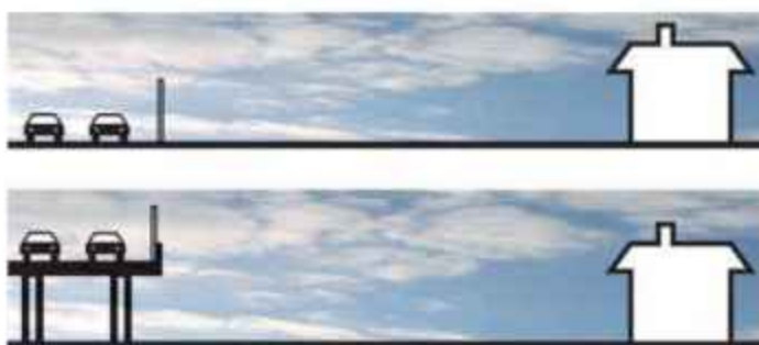
Слика 2.9. Пример постављања баријере близу пута или на вијадукту [24]
