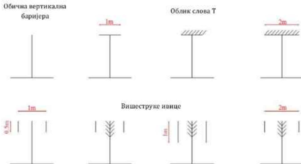
Слика 3.51 Дифракционе капе у облику слова Т (Прилагођено из [25])
