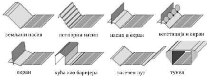
Слика 3.3. Различити типови рефлексионих баријера [44]
