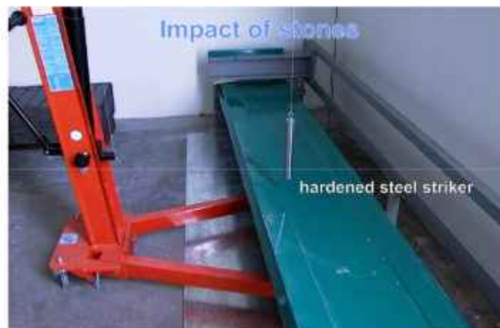
Слика 5.33. Испитивања отпорности на удар камена [109]
