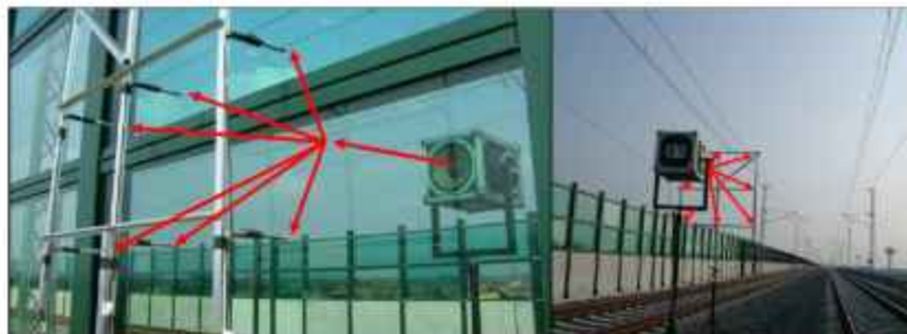
Слика 5.29. Мерење са 9 микрофона поред баријере у директном звучном пољу [109]
