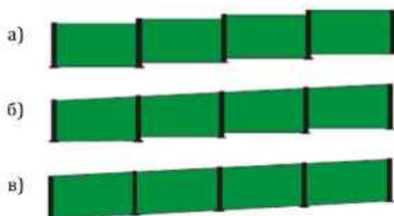
Слика 4.16 Варијације висине баријере у зависности од нагиба терена
