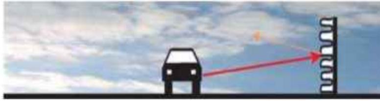
Слика 2.15. Пример баријере са звучно апсорбујућим површинама [24]
