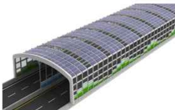
Слика 3.30. Тунелска баријера комбинована са соларним панелима [50]
